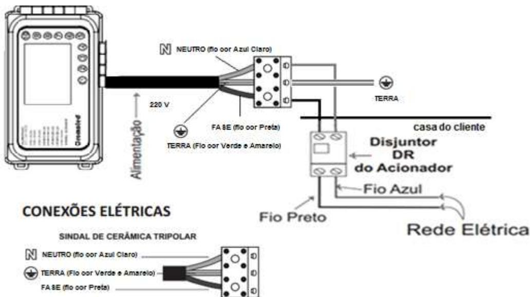
**⚠ IMPORTANTE PARA SUA SEGURANÇA:** para evitar riscos de choque elétrico, o fio terra deste equipamento deve ser conectado a um sistema de aterramento conforme normas da NBR-5410. A instalação elétrica e o sistema de aterramento para este equipamento devem ser executados por pessoas qualificadas.
