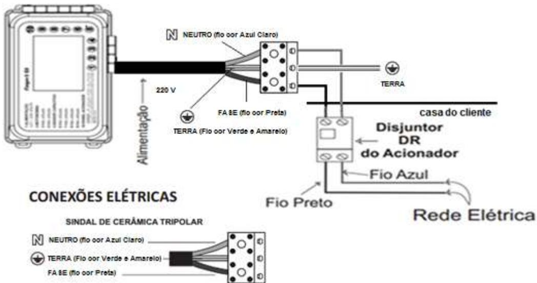
O Fio terra deverá ser sempre aterrado conforme norma NBR 5410. Nunca instale o acionador sem ligar o Fio Terra. (Ver item 3.4 – aterramento)
